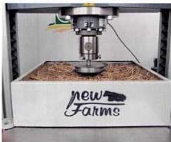
Abb. 3: Kalotteneindruckversuch [unten] nach Dauerttrittbelastung [oben]
