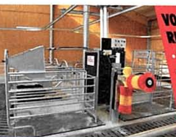
Kraftfutterautomaten mit Türen
